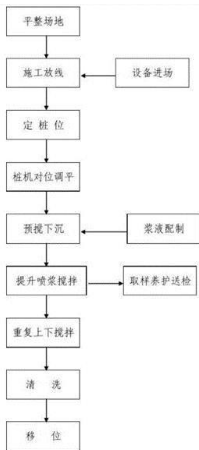
图 1-3 水泥搅拌桩施工工艺流程图
